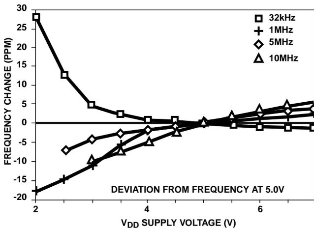
FIGURE 29. FREQUENCY CHANGE vs V<sub>DD</sub>
